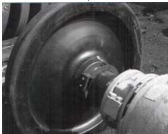
Рис. 3. Пример закрепления корректирующего груза на оси колесной пары
