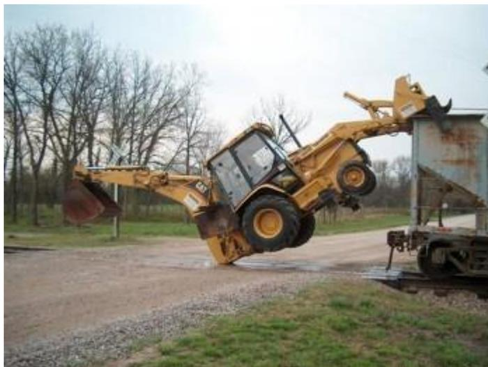
Американская компания Herzog Railroad Services разработала экскаватор CarTopper, который может самостоятельно взбираться на полувагоны. Такие экскаваторы используются ж/д перевозчики в Соединенных Штатах для загрузки и выгрузки полувагонов.
