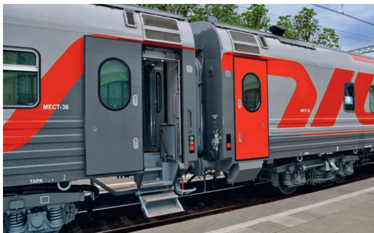
Двухвагонный сцеп купейного «Вагона-2019» (модель 61-4517)
